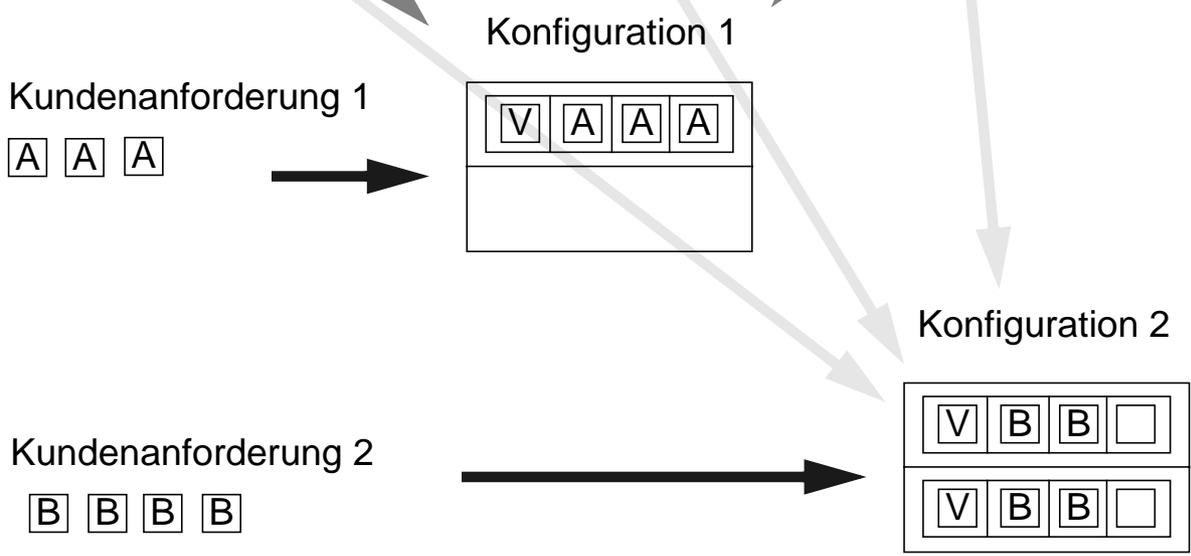
**Component-Port-Modell:** Zusammenstecken von Komponenten an bestimmten Ports
